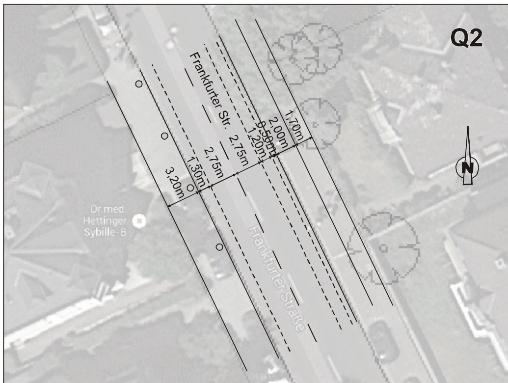
Bild 43: Querschnitt Frankfurter Straße, Abschnitt Benekestraße/Bahnhofsallee
