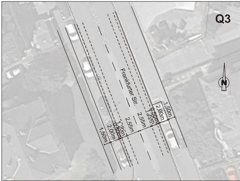
Bild 45: Querschnitt Frankfurter Straße, Abschnitt Bahnhofsallee/Eleonorenring
